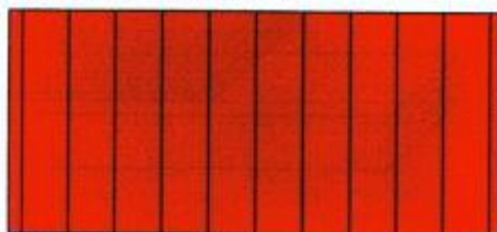
Вариант монтажа №2 Два листа заужены
